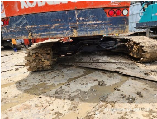
รูปที่ 39 วัสดุป้องกันการสั่นสะเทือนรองไวด์เครื่องจักร
